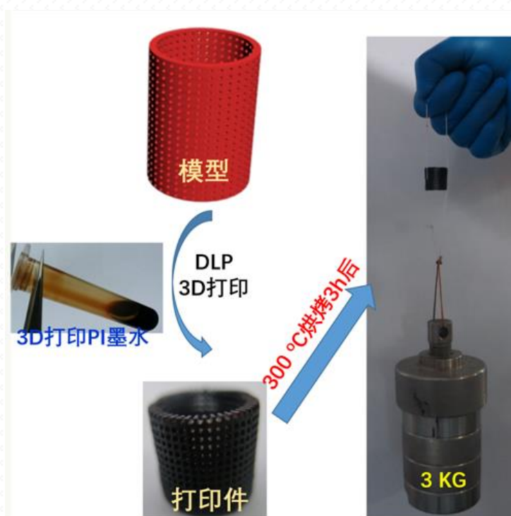
图 1: DLP 3D 打印聚酰亚胺滤油器网塞及 300^{\circ}\text{C}/3\text{h} 高温烘烤实验
