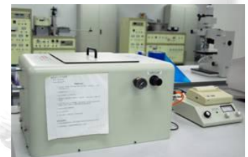
棱镜耦合仪 ：主要用于两个波长（1547nm, 633nm）下体材料折射率、光学薄膜厚度和折射率、双层膜厚度和折射率的测定
