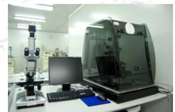
台阶仪 ：用于测量样品表面
